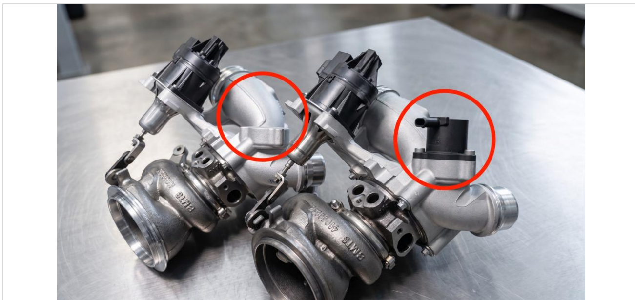
Vlevo: nová revize bez ventilu (index 07) · Vpravo: starší revize s přepouštěcím ventilem (index 06) Left: new valve-less revision (index 07) · Right: earlier revision with diverter valve (index 06)
